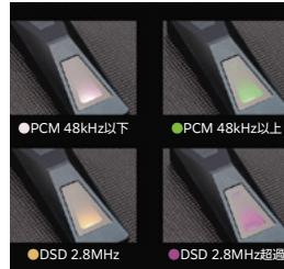
RGBインジケーターライトを備え、再生中の楽曲のサンプリングレート/フォーマットに合わせて色が変化する。なお、Android端末等のUSB Type-C同士での接続の場合、PCM 48kHz未満で薄いピンクに、PCM 48kHz以上で緑に、DSD 2.8MHzでオレンジに、DSD 2.8MHz超過でピンクに変わる。※ただし、iPhoneでLightning to USB Type-Cで接続した場合、上記通りに色が変わらない可能性もある。
